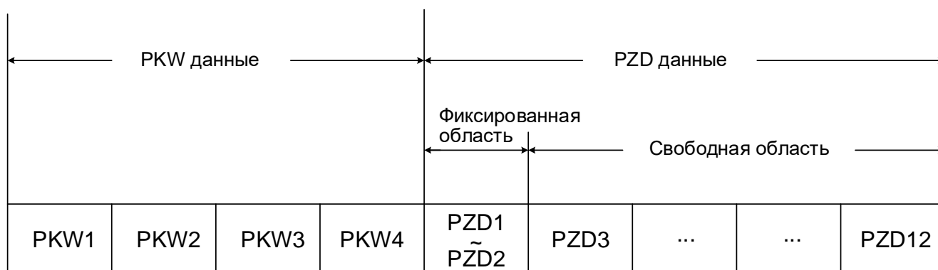
Рисунок 3-1 Структура данных информационного кадра Profinet
