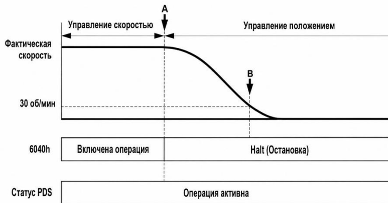
Рисунок 7–5 — Диаграмма показывает изменение скорости и статуса PDS при выполнении команды остановки.
