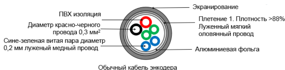
Рисунок 3-6 — Схема поперечного сечения стандартного кабеля энкодера с указанием материалов и размеров.
