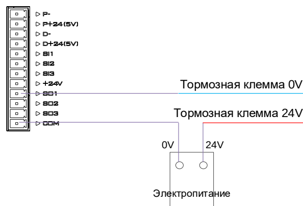
Рисунок 6–7 — Схема подключения тормоза для привода мощностью 400 Вт или ниже.
