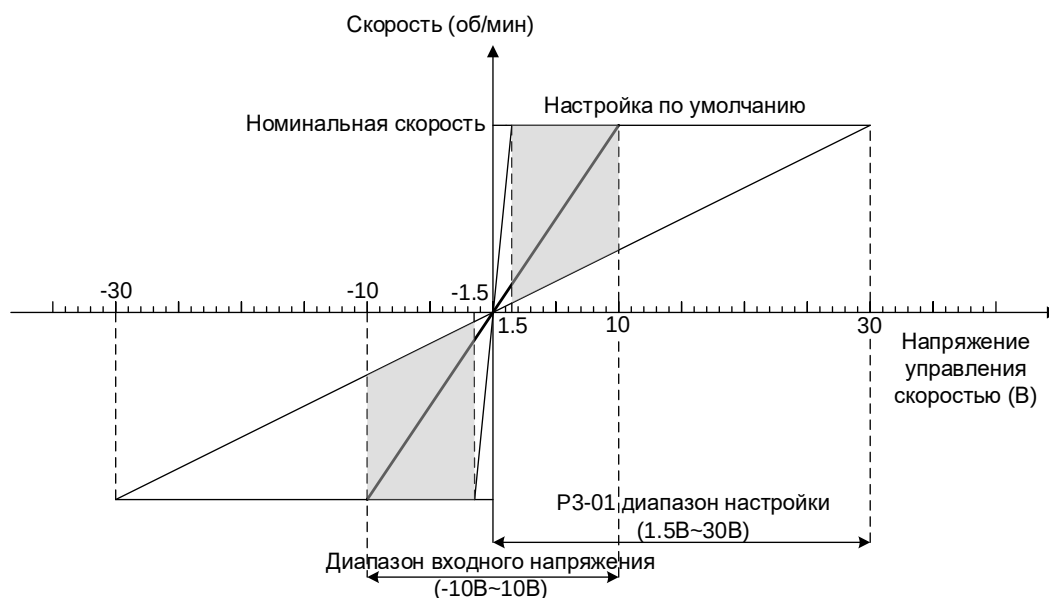
Рисунок 6–52 — График зависимости скорости вращения от напряжения команды скорости с указанием диапазона настроек.
