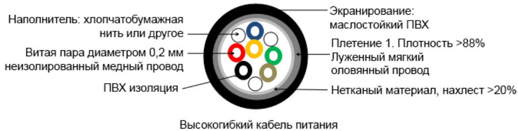
Рисунок 3–7 — Поперечное сечение высокогибкого кабеля энкодера с указанием материалов и конструкции.
