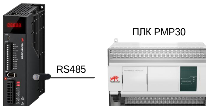
Рисунок 9–2 — Схема подключения сервопривода к ПЛК по интерфейсу RS-485.
