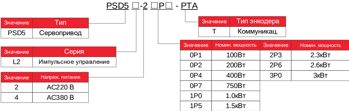
Рисунок 2–1 — Расшифровка обозначения модели сервопривода PSD5.
