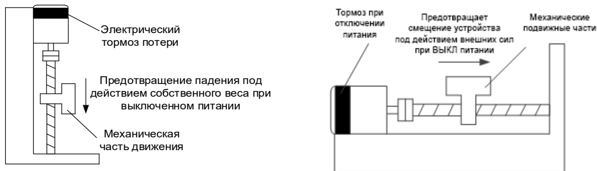
Рисунок 6–3 — Принцип работы тормоза при отключении электропитания для предотвращения падения механической части.
